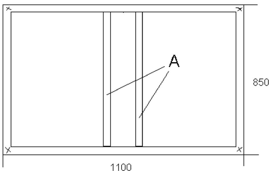
2. Vertikalne cevi (A) vare se prema osnom rastojanju otvora (rupa kroz koje prolaze navrtke kojima se pri vrš uje obru) na obru u koji imate u odnosu na vertikalnu osu rama.
